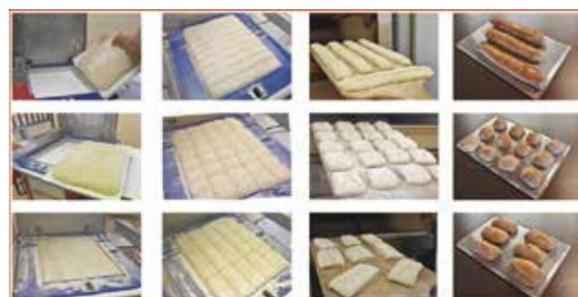
由面包师将搅拌机内的或者冷冻发酵好的面团称重分批倒入面盘，这台机器有分割和成型双重功能。
